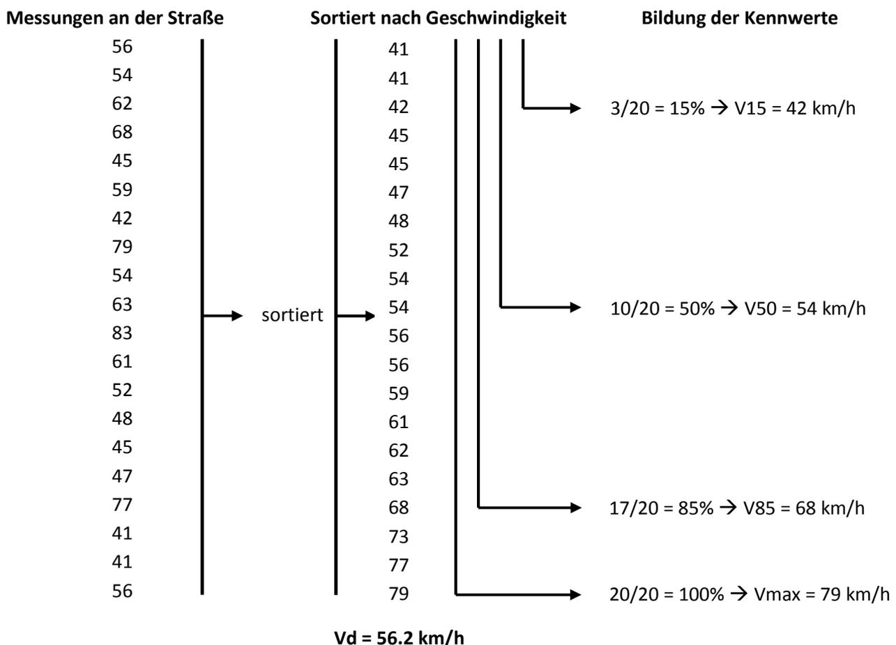
Lesebeispiel: „3 von 20 Messungen entsprechen 15% (=3/20). Die Geschwindigkeit des dritt-langsamsten Fahrzeuges ist 42 km/h. Demzufolge ist v15 = 42 km/h“
