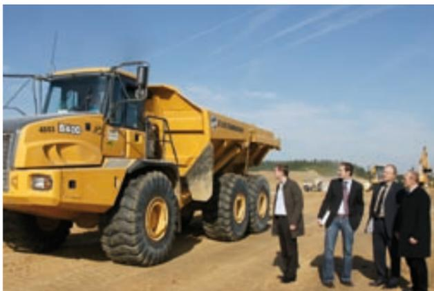
SCHIERLING. Der Bau der B 15 neu westlich von Schierling war im Jahre 2008 die größte und spektakulärste Baustelle. Beginnend an der Kreisstraße R 35 bei Allersdorf wurden im September die Erdbauarbeiten aufgenommen. Insgesamt werden im Abschnitt bis Saalhaupt rund 930000 Kubikmeter Erdmaterial bewegt. Es werden Einschnitte ausgebagert und mit dem gleichen Material andernorts Seitenablagerungen für zusätzlichen Lärmschutz getätigt.
