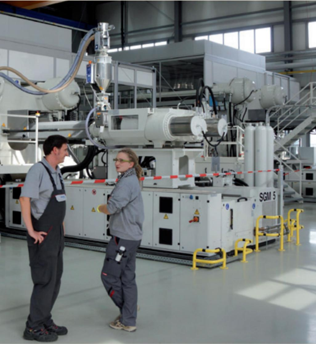
Drei imposante neue Spritzgussmaschinen sind der Blickfang im neuen Teil des Webasto-Werkes Schierling, in dem vorwiegend Polycarbonat-Schiebedächer für den chinesischen Markt produziert werden
