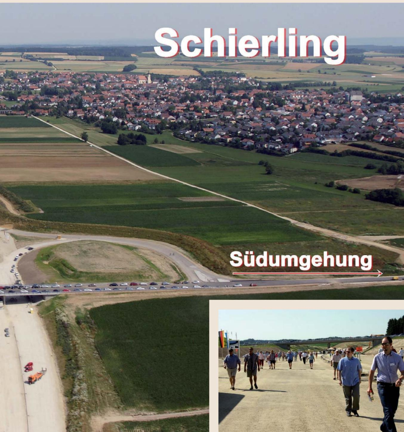
die höchsten Dämme sind bis zu 12 Meter. Besonders im Tal der Großen Laber sei der Baugrund „sehr anspruchsvoll“ gewesen. Weil bis zu drei Meter dicke Torfschichten angetroffen wurde, waren rund 60.000 laufende Meter Rüttelstopfsäulen zur Stabilisierung nötig. Außerdem wurden zur Bodenbearbeitung zwischen Schierling und Saalhaupt 30.000 Tonnen reiner Kalk verbaut.
