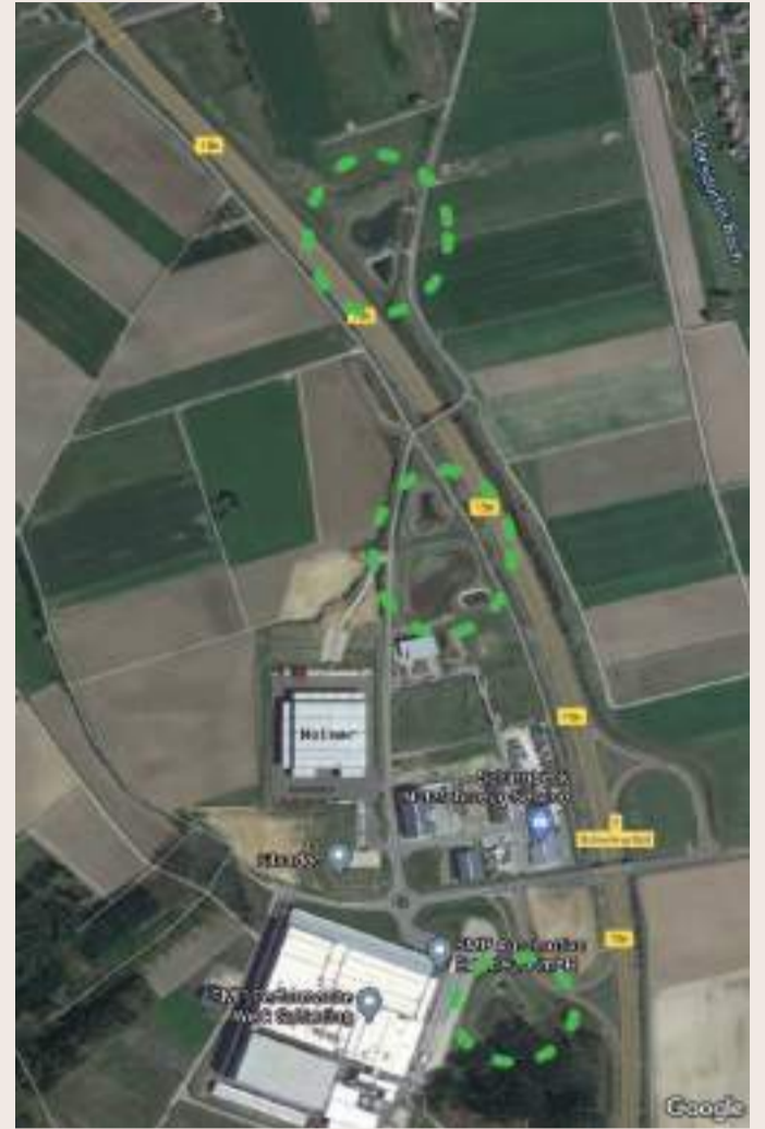
Ein Fassungsvermögen von rund 10.000 Kubikmetern haben die öffentlichen Regenrückhaltebecken im und am Gewerbegebiet „Am Birlbaum“ entlang der B 15neu
