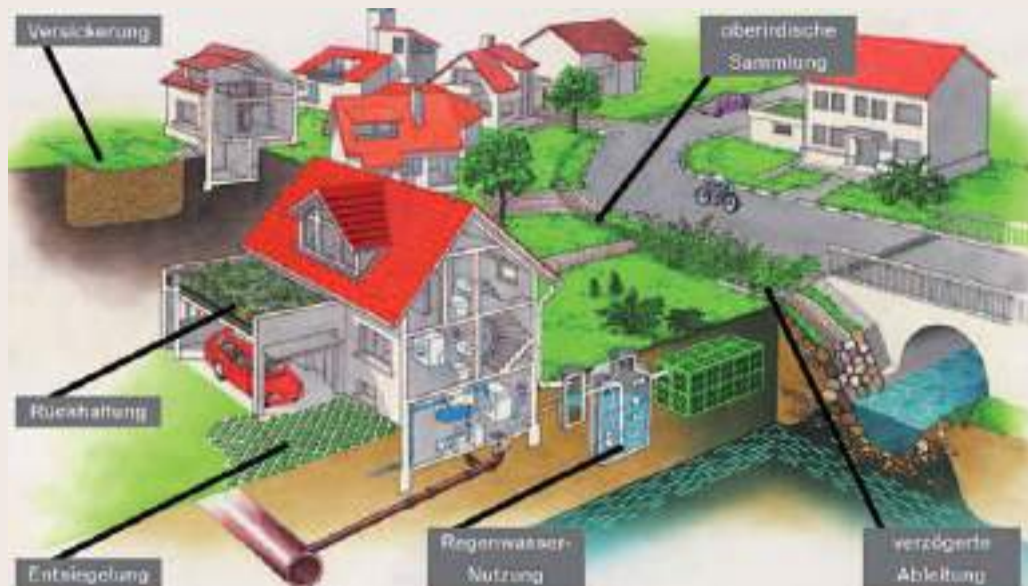
Im bayerischen Leitfaden werden mit einem Schema die verschiedenen Möglichkeiten der Regenwasserbewirtschaftung anschaulich gemacht
