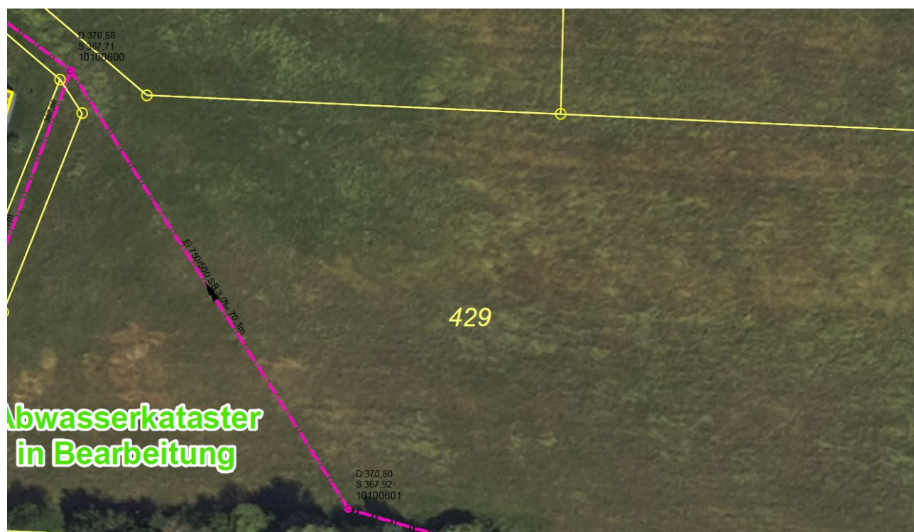
Abbildung 3 Lageplan Freispiegelkanal im Eiprofil, Höhe 750 mm und Breite 500 mm
